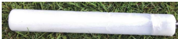
图 1 实验模拟覆冰输电线试样
