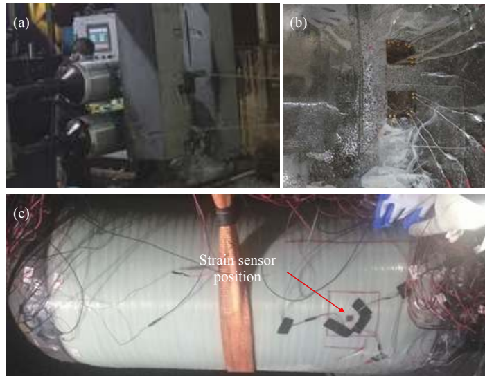
图 1 具有原位监测功能的复合材料压力容器制备过程: (a) 纤维缠绕工艺, (b) 粘贴在金属内胆的应变片, (c) 带有埋入式应变片的纤维缠绕压力容器
