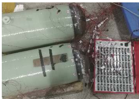
图 2 纤维缠绕压力容器原位监测装置
