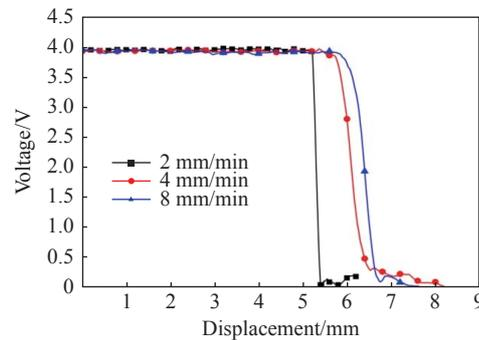
图7 电池在不同加载速度下的电压-变形曲线
