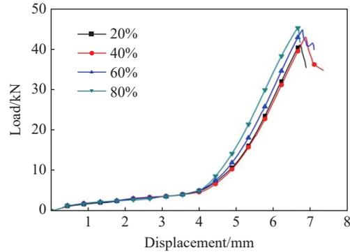
图 3 不同荷电状态电池载荷-变形曲线
