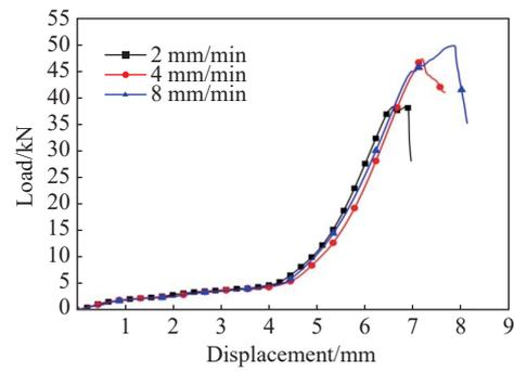
图6 电池在不同加载速度下的载荷-变形曲线
