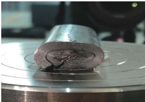
图 4 压缩后锂离子电池的横截面
