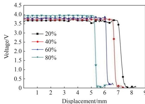
图 5 不同荷电状态电池电压-变形曲线
