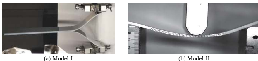
图 5 断裂韧性测试试验照片
