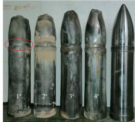
图 6 实验前后弹体外观比较
