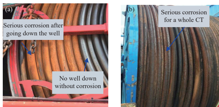
图 2 连续管腐蚀后的形貌
