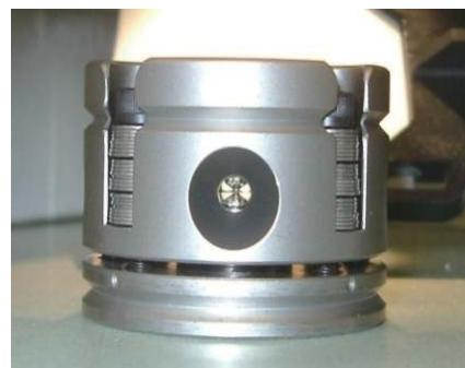
图 10 DAC 高压装置
