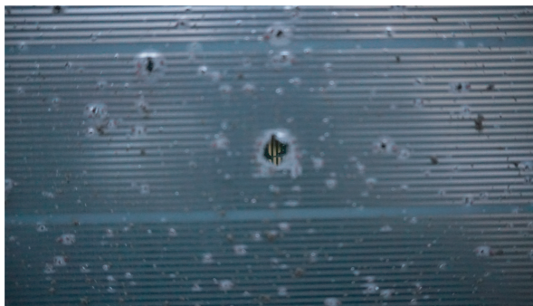
图 10 破片穿透梳状靶的局部状态
