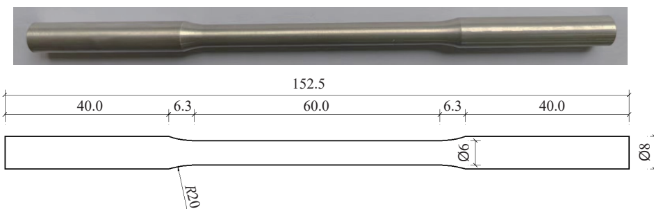
图 3 准静态拉伸试样的照片和尺寸(单位: mm)
