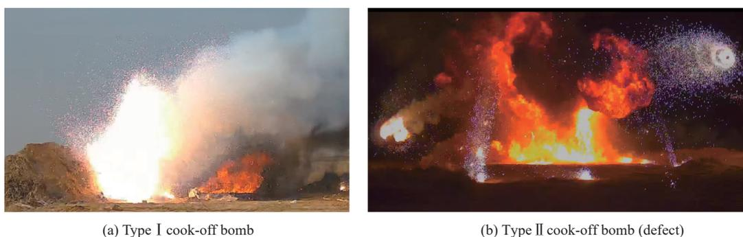
图 5 两型弹响应时的状态
