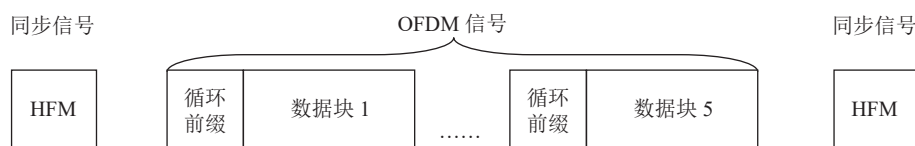
图 7 松花江试验 OFDM 信号帧结构示意图
