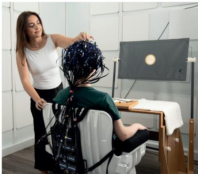
一种量子磁探测器被用于构建一种穿戴式的脑成像设备，通过探测神经电活动产生的极弱磁场，OPM-MEG可以对脑功能活动进行成像。这种头盔式的探测器系统相比其他脑成像方法具有更小的尺寸和更大的头部可移动性
