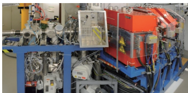
用于合成钅-252的充气反冲分离器
