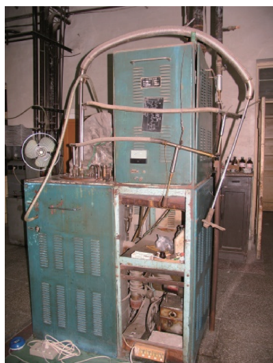
图4 我国第一台CHY-20型长活塞氨膨胀机液化器
