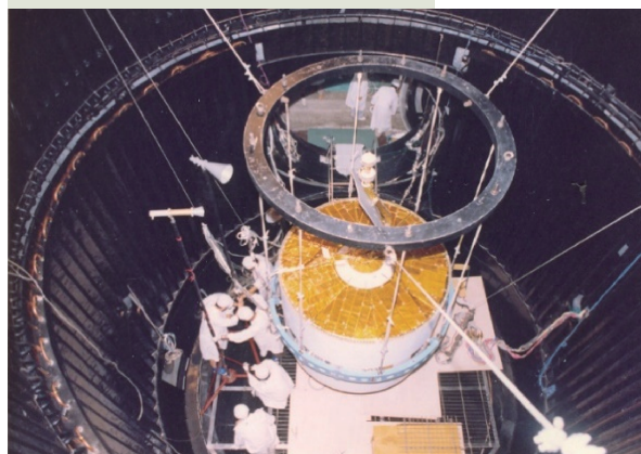
图5 中国通信卫星在北京卫星环境工程研究所KM4设备热沉环境中做真空热试验准备的照片 [9]
