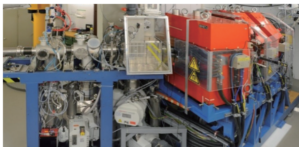
用于合成钅-252的充气反冲分离器
