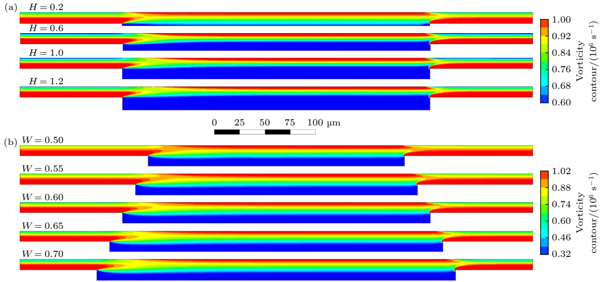
图 4 润滑模型 I 和 II 中的上表面涡量云图 (a) 模型 I; (b) 模型 II Fig. 4. Distribution of vorticity in models I and II: (a) Model I; (b) Model II.
