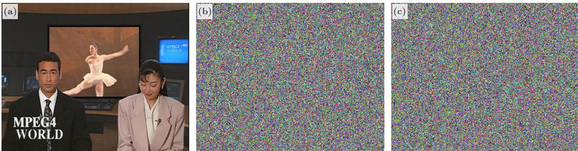
图 20 密钥敏感性分析 (News 第 91 帧) (a) 使用正确密钥解密的帧图像; (b) 使用错误密钥解密的帧图像 ( $y(1) = 0.5 + 10^{-16}$ ); (c) 使用错误密钥解密的帧图像 ( $q = 0.95 + 10^{-16}$ )
