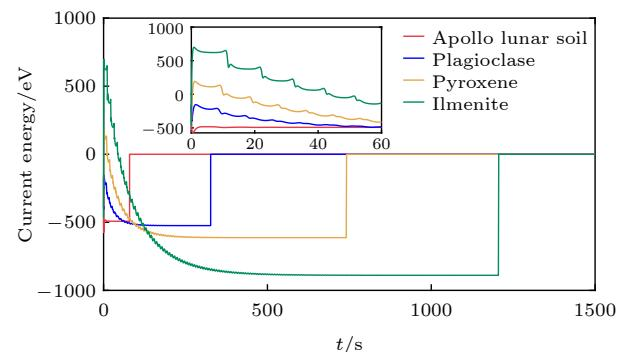
图 6 正午时分 4 种尘埃颗粒的电流能, 0—60 s 的结果已被绘制为内插图
