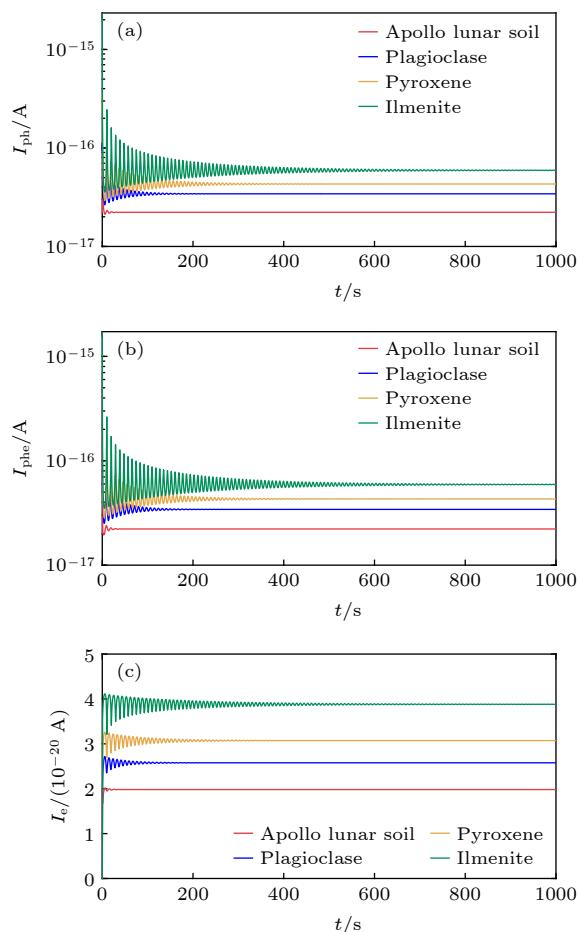
图 5 正午时分悬浮尘埃颗粒的充电电流 (a) 光电子发射电流; (b) 光电子收集电流; (c) 太阳风电子电流
