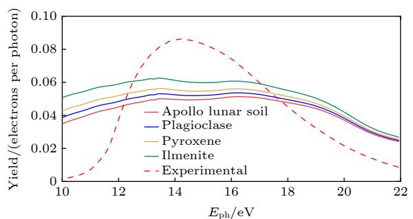
图 3 4 种不同功函数尘埃的光电子产率. 实线表示使用 Kimura 方法计算的产率, 红色实线代表阿波罗月球土壤, 蓝色实线代表斜长石, 黄色实线代表辉石, 绿色实线代表钛铁矿. 红色虚线表示阿波罗月球土壤的实验产率
