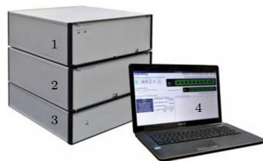
图 3 N4-21 量子电压的桌面测控部分, 包括: 1. 制冷模块, 2. 测试模块, 3. 控制与电源模块, 4. 电脑 [42]
