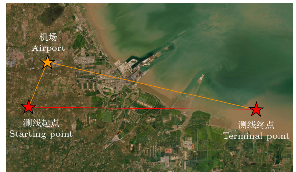
图 5 飞行路线 (红线为重力测线, 橙线为往返路线)
