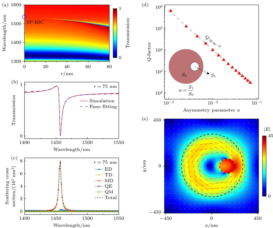
图 3 (a) 玻璃衬底上硅纳米盘超表面的透射谱相对于偏心孔半径的变化, SP-BIC 的对应位置使用篮圈标记; (b) 在  $r = 75 \text{ nm}$  时的透射光谱, 以及与法诺公式拟合曲线的对比; (c) 在  $r = 75 \text{ nm}$  时, 硅超表面共振的多级展开, 可以看出在共振波长位置处 MD 响应占绝对的主导地位; (d)  $Q$  因子和不对称参数  $\alpha$  的关系, 为直观反映两者之间的关系采用对数坐标绘制; (e) 在  $r = 75 \text{ nm}$  的情况下共振时的  $x$ - $y$  平面电场分布图像, 红色箭头表示面内循环位移电流
