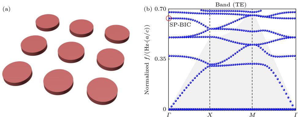
图 2 (a) 由周期排列的硅纳米盘阵列组成的超表面示意图; (b) 计算出图 (a) 中周期排列的硅纳米盘阵列的光子带结构, 灰色阴影表示位于自由空间光锥下方的区域, 被困的对称保护的 BIC 位置用红圈标记
