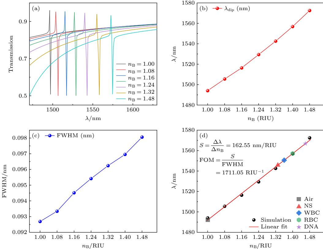
图 4 (a) 不同背景折射率下的透射光谱; (b) 共振波长随背景折射率的变化; (c) 半高宽 FWHM 随背景折射率的变化; (d) 对共振波长随背景折射率红移变化的线性拟合, 灵敏度  $S$  和优值 FOM 根据拟合梯度计算, 在拟合直线中标记了多种生物成分的 RI
