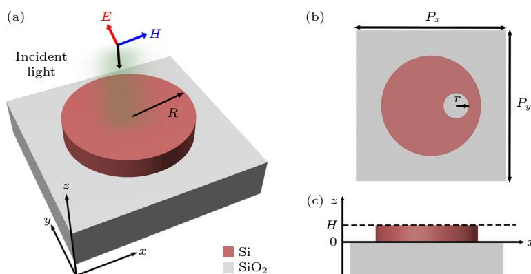
图 1 (a) 所提出的全介质超表面示意图, 结构参数为  $P_x = P_y = 900 \text{ nm}$ ,  $R = 300 \text{ nm}$ ,  $H = 100 \text{ nm}$ , 玻璃衬底的厚度设定为  $1000 \text{ nm}$ ; (b) 在距离盘中心  $150 \text{ nm}$  的固定距离内引入一个半径  $r$  可变的偏心孔以破坏结构的  $C_2$  对称性; (c) 硅纳米盘超表面的前视图
