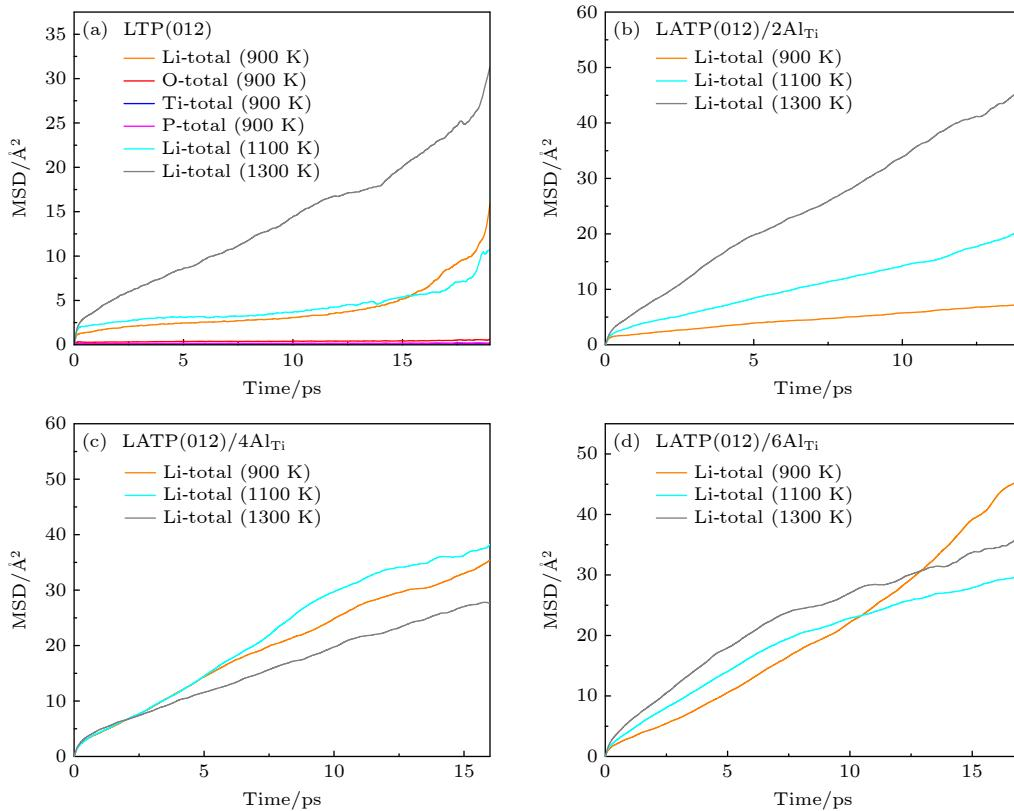
图 6 在温度为 900, 1100 和 1300 K 时,  $\text{Li}^+$  在 LTP(a) 和 LATP (012) (b)–(d) 表面上的 MSD 随时间的变化曲线图
