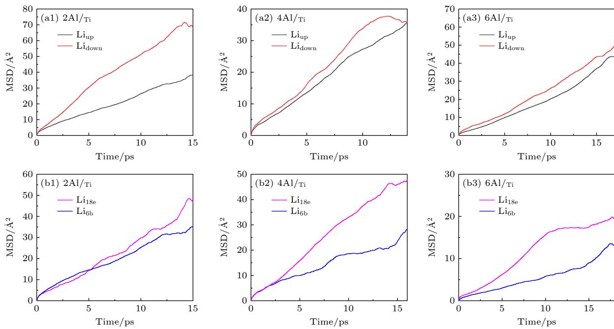
图 7 三种 LATP(012) 表面结构中不同位置 Li 的扩散情况 (a1)—(a3) 为不同原子层的  $\text{Li}^+$  的 MSD 图; (b1)—(b3) 为最表层中  $\text{Li}_{6\text{b}}$  和  $\text{Li}_{18\text{e}}$  位的  $\text{Li}^+$  的 MSD 图
