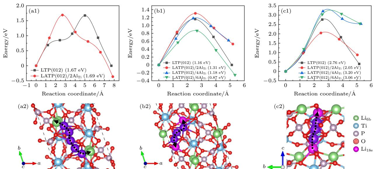
图 5  $\text{Li}^+$  在 LTP 和 LATP 表面上的迁移势垒和相应迁移路径 (a1), (a2) 最表层空位迁移; (b1), (b2) 最表层间隙位迁移; (c1), (c2) 次表层到最表层间隙位
