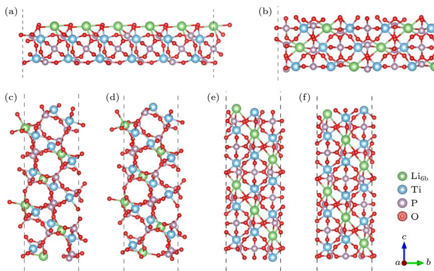
图 1 不同晶面的 LTP 表面结构图 (a) Li-LTP (012); (b) O-LTP (100); (c) O-LTP (101); (d) Ti-LTP (101); (e) Li-LTP (001); (f) Ti/O-LTP (001)
