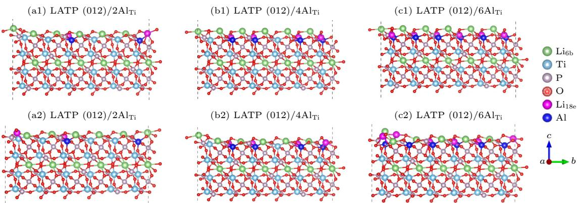
图3 (a1)–(c1) 优化前不同Al含量下的LATP(012)表面模型; (a2)–(c2) 优化后不同Al含量下的LATP(012)表面模型
