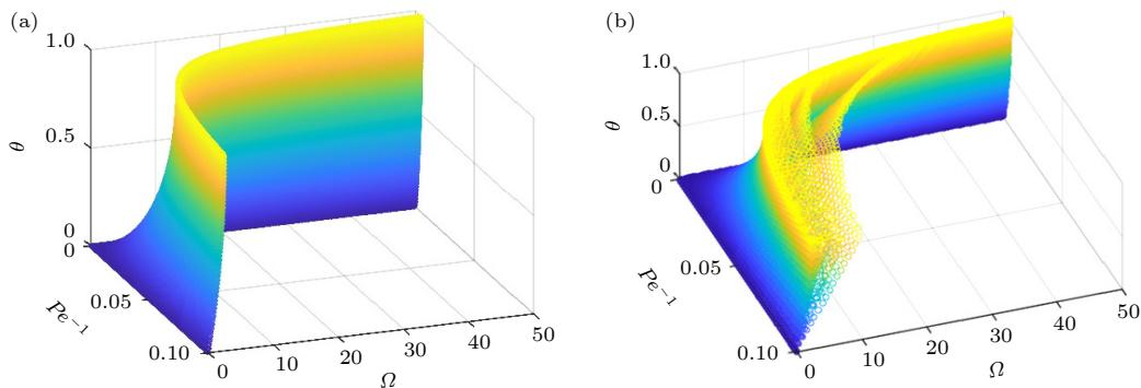
图 10 从微观参数对  $(\lambda, l, C_v)$  计算宏观参数对  $(Pe^{-1}, \theta, \Omega)$  的结果 (a)  $\alpha = 1$ ; (b)  $\alpha < 1$
