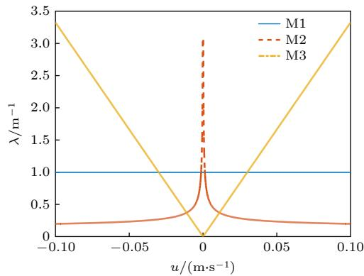
图 11 三个微尺度过滤系数模型 (平均速度的正负代表粒子运动方向)
