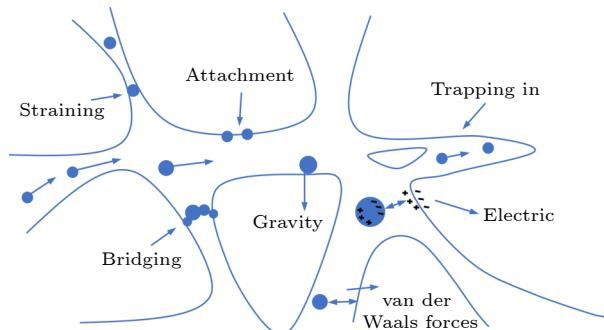
图 1 孔隙尺度下多孔介质中粒子所受作用力和捕获机制
