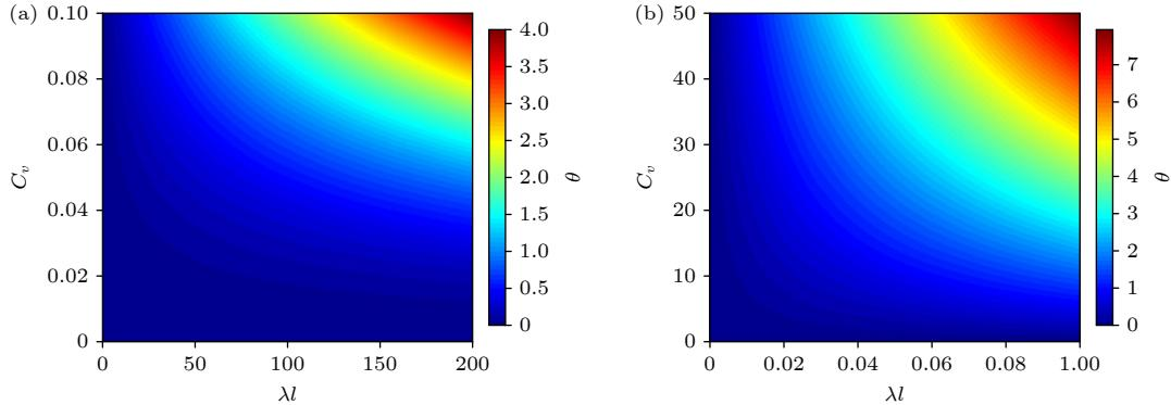
图 8 本文模型的宏观系数  $\theta$  对  $C_v$  和  $\lambda l$  的敏感性分析 (a)  $C_v \in (0, 0.1]$ ,  $\lambda l \in [0, 200]$  ; (b)  $C_v \in (0, 50]$ ,  $\lambda l \in [0, 0.1]$
