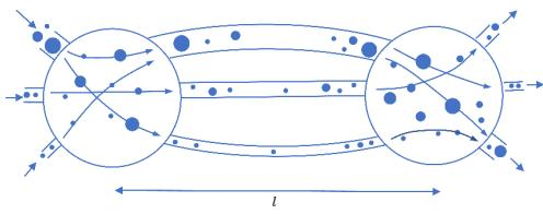
图 3 多孔介质中粒子输运和捕获示意图
