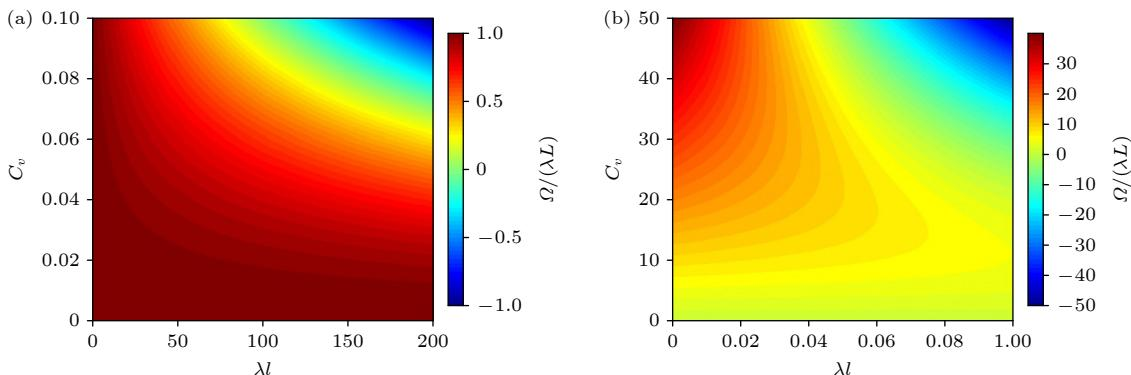
图 9 本文模型的宏观系数  $\Psi = \Omega / (\lambda L)$  对  $C_v$  和  $\lambda l$  的敏感性分析 (a)  $C_v \in (0, 0.1]$ ,  $\lambda l \in [0, 200]$ ; (b)  $C_v \in (0, 50]$ ,  $\lambda l \in [0, 0.1]$
