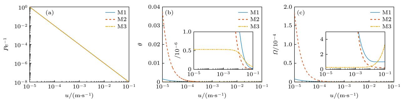
图 12 三种捕获机制下的宏观系数关于平均速度  $u$  的灵敏度研究 ( $s = 10^{-2}$ ,  $l = 10^{-6}$ ,  $\alpha = 0.5-1$ ) (a)  $Pe^{-1}$ ; (b)  $\theta$ ; (c)  $\Omega$
