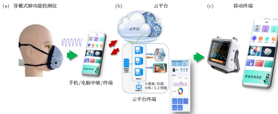
图2 本研究中开发的整体系统示意图, 基于柔性传感的定量呼吸波系统由3个主要组件组成, 即穿戴式肺功能检测仪、云平台 and 移动终端
