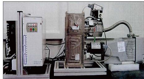
图5 Mynemi 用低温吸附方法研制的超灵敏度真空检漏仪样机
