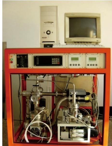
图10 清华大学陈旭等研制出下限为  $10^{-15} \text{ Pa}\cdot\text{m}^3/\text{s}$  量级的超灵敏度真空检漏仪
