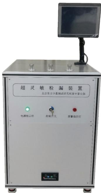
图12 卢耀文等研制出下限为  $5 \times 10^{-16} \text{ Pa} \cdot \text{m}^3/\text{s}$  的超灵敏度真空检漏仪实物图
