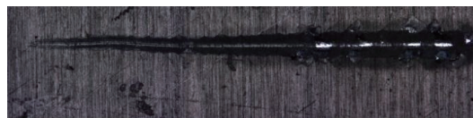
图5 划痕实验中多孔阳极氧化铝的金相显微镜图像
