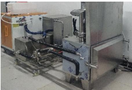
图1 蒸汽烫漂与热风真空干燥设备实物图
