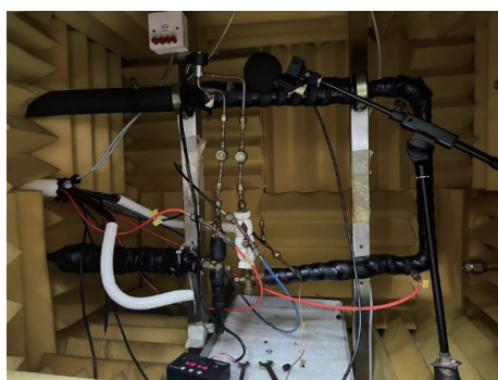
图3 电子膨胀阀测试台示意图
