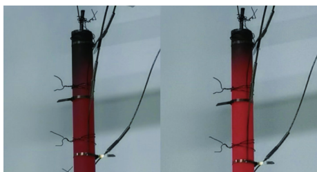
图6 无芯钠热管启动后冷凝段冲管现象
