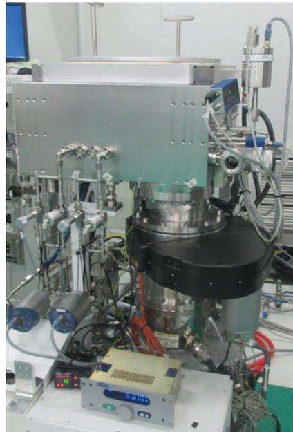
图11 静电卡盘吸附力测试实验装置
