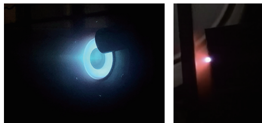
图9 C12A7空心阴极放电及其与200 W HET-50联合运行的照片 [65]
