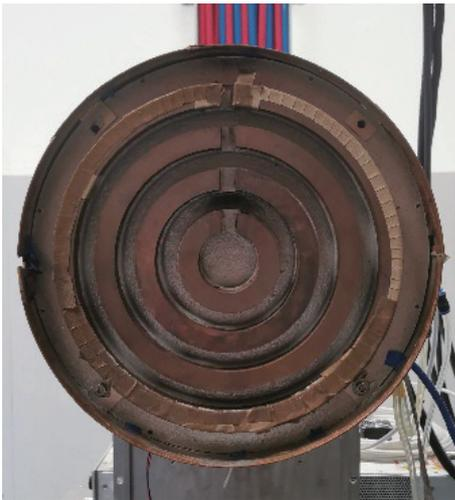
图3 LEAD装置的蚊香形天线照片,采用了4组环形设计,每组环都可以单独控制电流方向
