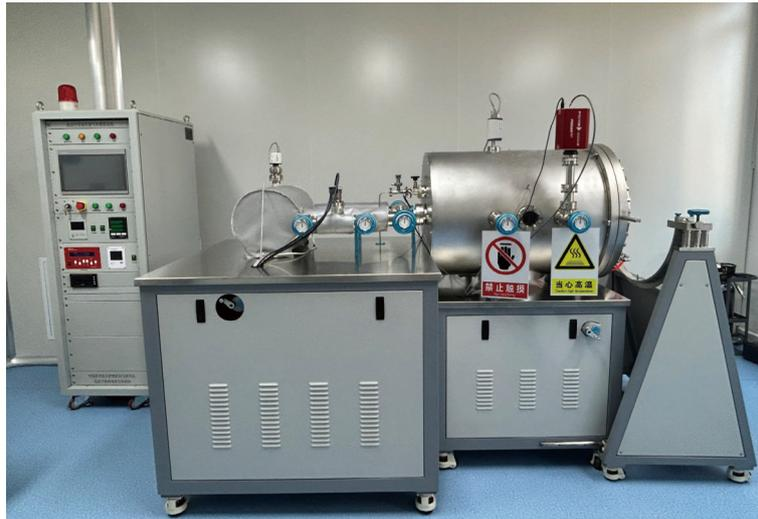
图12 真空放气率测试装置
