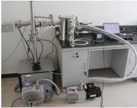
图8 多种类示漏气体实验系统
