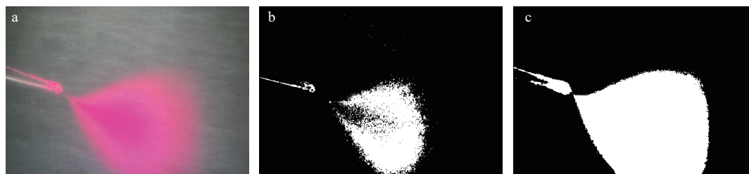
图2 原图(a)、依据灰度值(b)和反射率值(c)设置的阈值
